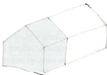
Schéma d'une extension en pignon reprenant le gabarit du volume secondaire
